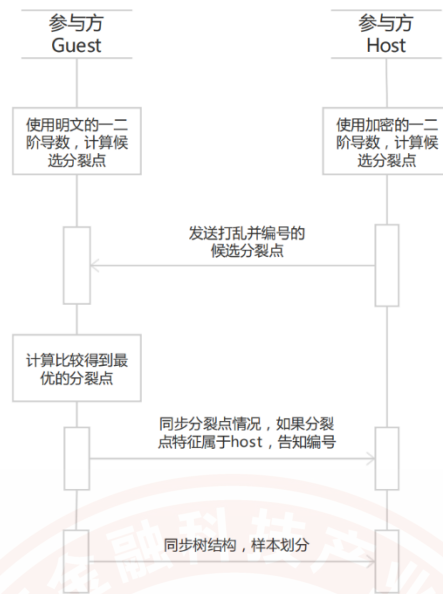
图 20 纵向提升树模型训练（两方）协议二的数据交换流程
